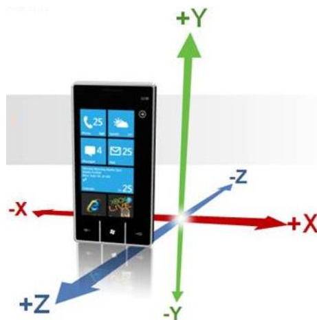
Figure 2-10 : Axes de l'accéléromètre d'un smartphone Windows Phone 7 [AND 10]
